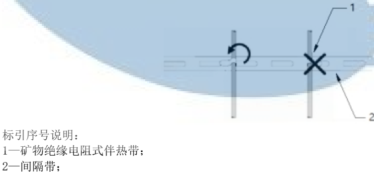
图11 间隔带固定伴热带示意图
